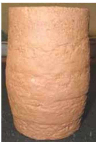
Figura 11: Amostra após ensaio triaxial consolidado não drenado
