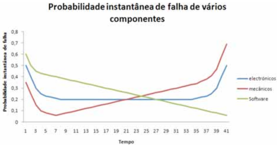
Figura 3: Probabilidade instantânea de falha de vários tipos de componentes
