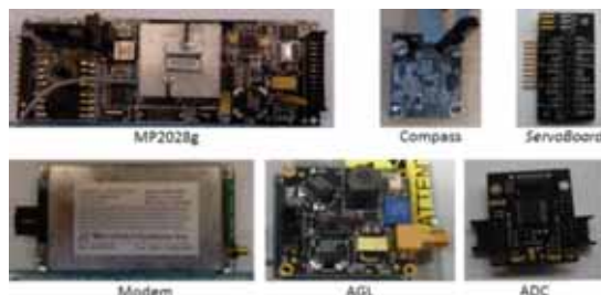
Figura 1: Componentes do MicroPilot
