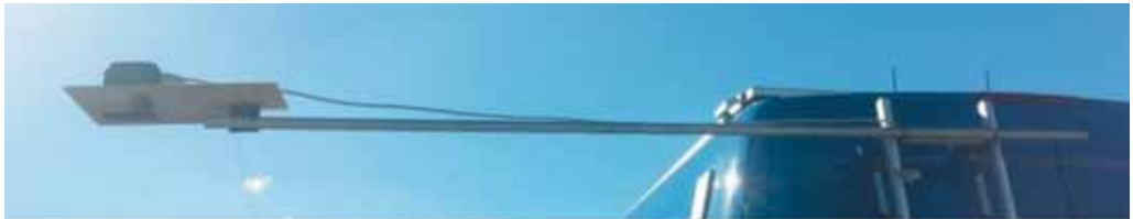
Figura 6 - «Braço extensor» para o suporte do Sensor AGL, construído para os testes em movimento.
