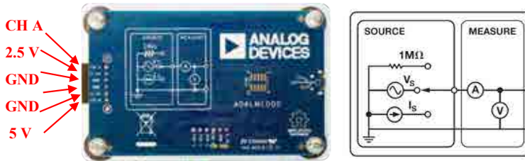
Figura 11 - a) Placa ADALM1000; b) Esquema de geração e medição de sinais
