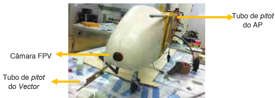
Figura 3 3 - Montagem da câmara de vídeo e tubo de pitot no nariz.
